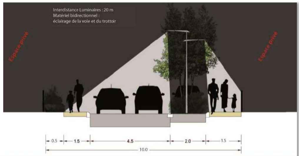
Coupe de nuit avec représentation du fonctionnement de l'éclairage.
