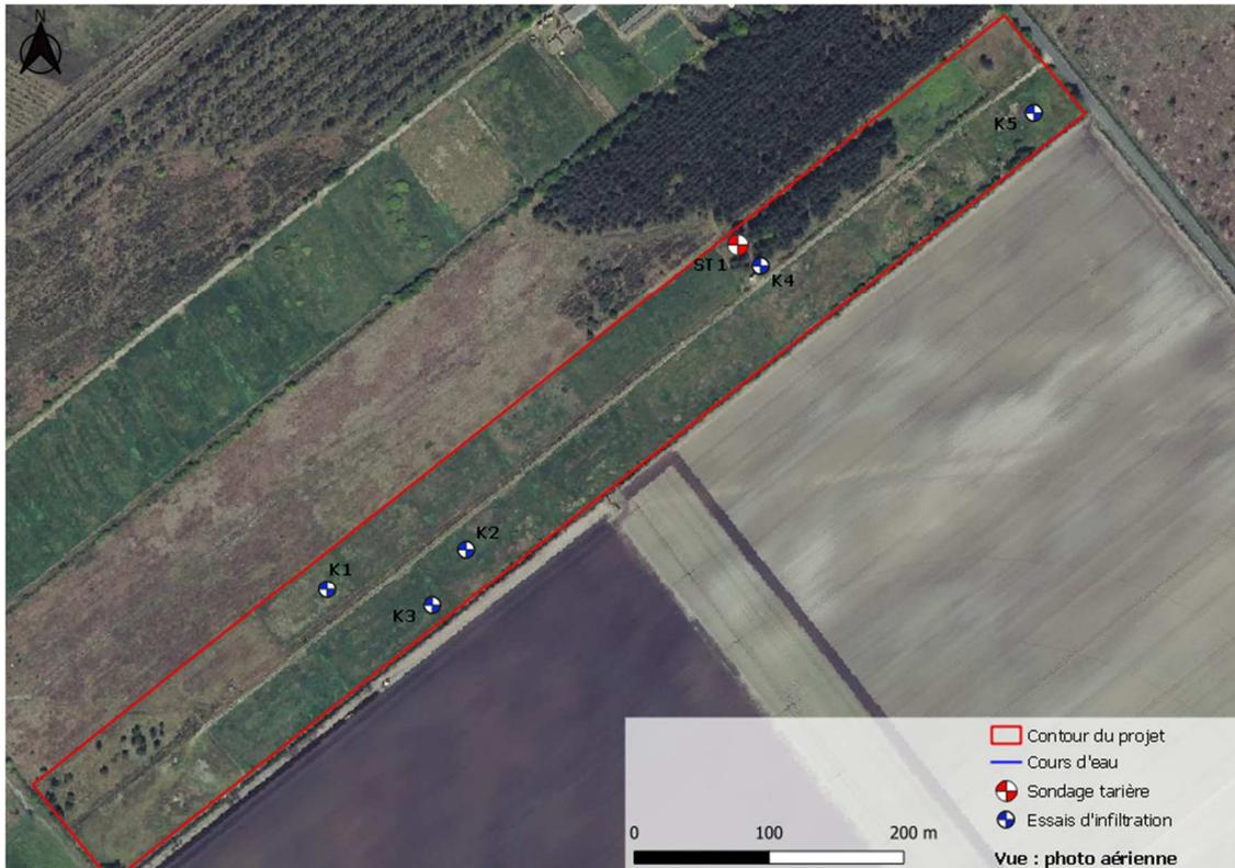
Figure 16 : Localisation des essais d'infiltration et du sondage tarière (Source : Google Sat)
