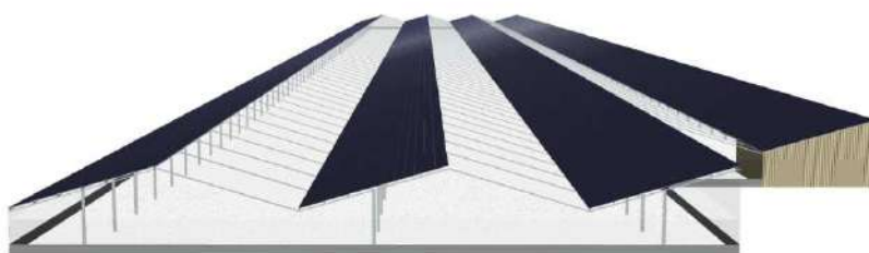
Figure 3 : Vue 3D – Hangars d'élevage type volières photovoltaïques
